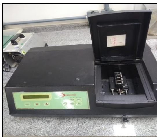
Figura 2. Ilustração do espectrofotômetro, aparelho utilizado para padronização dos inóculos bacterianos
