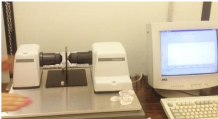
Figura 1 – Espectrofotômetro de infravermelho. Fonte: Arquivo pessoal.
