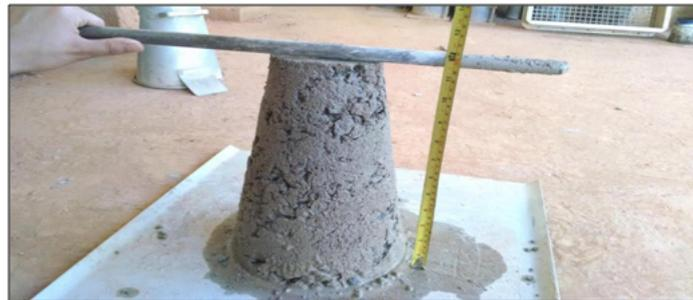
Figura 7 – Slump Test. Fonte: acervo pessoal (2015).
