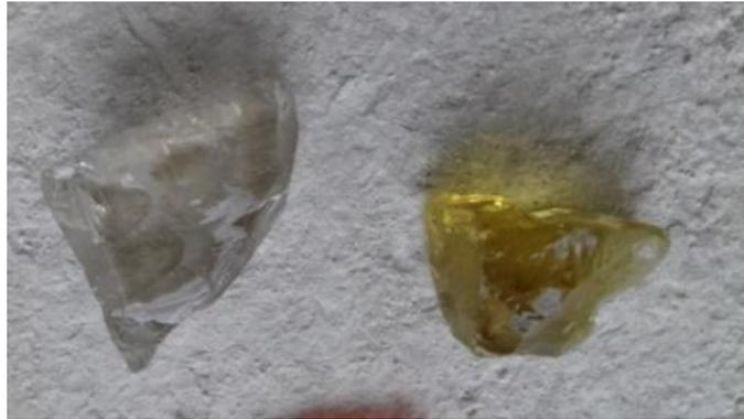
Figura 3 – Amostras de Araçuaí 1, após 15 minutos no forno. Fonte: Arquivo pessoal.
