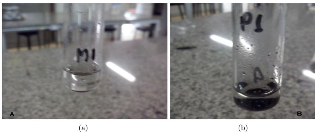
Figura 5 – Ataque com ácido sulfúrico ( $H_2SO_4$ ) concentrado. A) Material da memória; B) Material da placa-mãe. Fonte: Corcini e Gonzaga (2015, p. 43).
