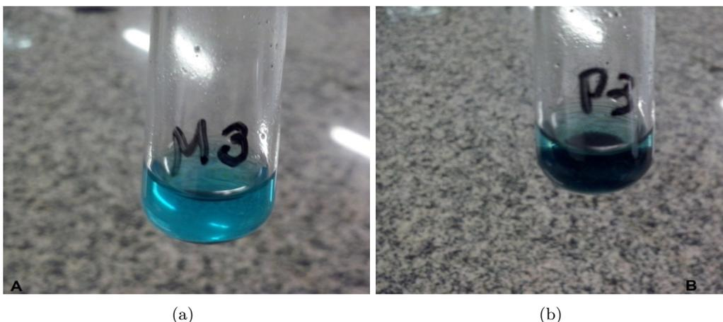
Figura 7 – Ataque com ácido nítrico (HNO<sub>3</sub>) concentrado. a) Material da memória; b) Material da placa-mãe. Fonte Corcini e Gonzaga (2015, p.44).
