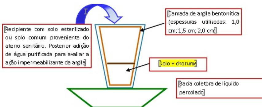
Figura 1 – Esboço da simulação de aterro sanitário realizada.
