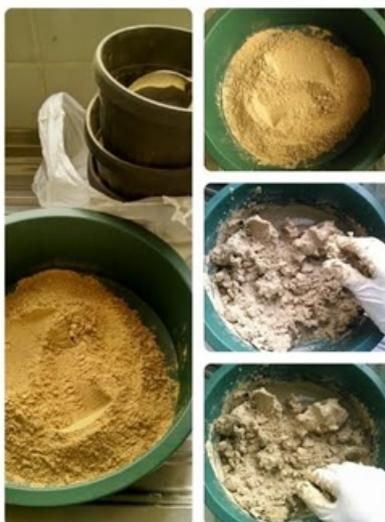
Figura 2 – Foto ilustrativa do processo de ativação da argila bentonítica.
