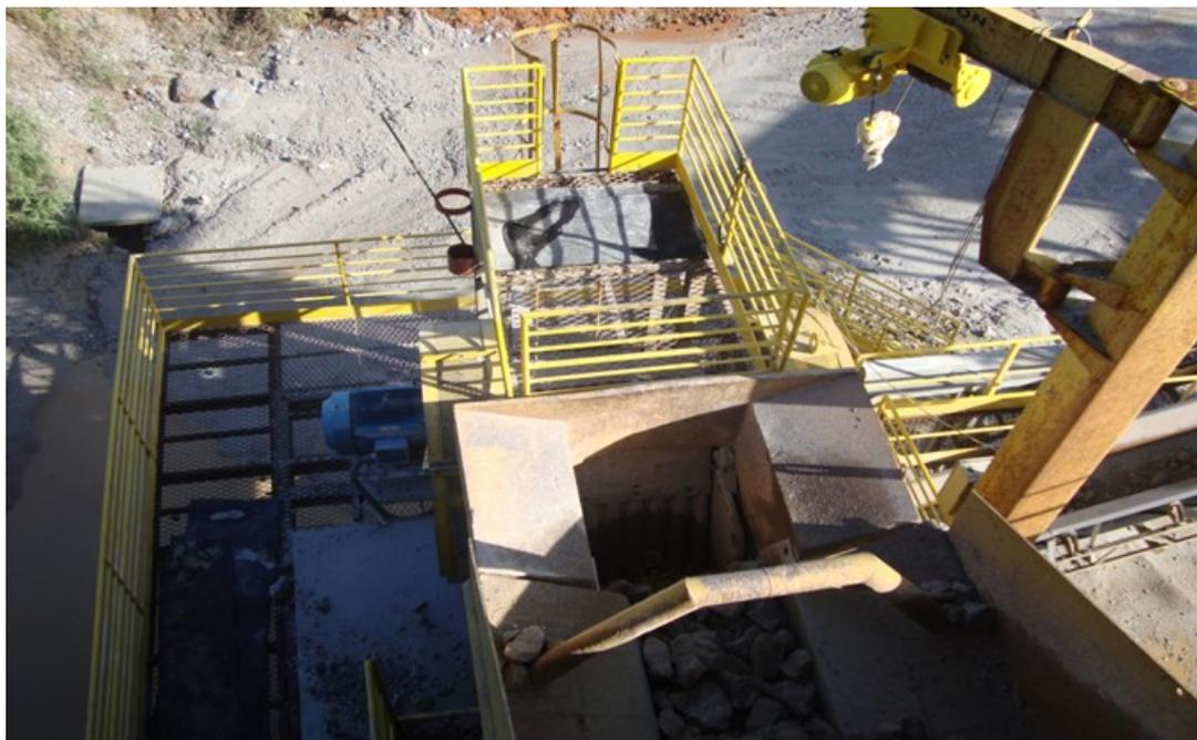
Figura 3 – Vista superior do britador de mandíbulas.
