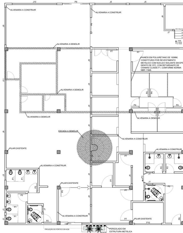
PLANTA BAIXA - DEMOLIÇÃO E CONSTRUÇÃO
